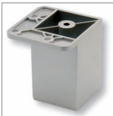
8110/70 H = 70 mm 62x62 (46x46 mm) furattávolság: 32 mm teherbírás: max. 200 kg króm 00014103710 alumínium 00014103711 matt nikkél 00014103712
