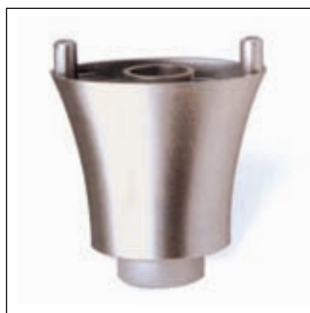
0756 H = 60 mm 75x48 / ø32 mm állíthatóság: +8 mm csapméret: ø8x10 mm furattávolság: 64 mm teherbírás: max. 100 kg króm 00014103200 alumínium 00014103203 matt nikkél 00014103206
