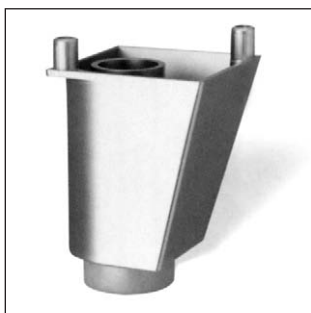
0762 H = 65 mm 56x56 / ø32 mm állíthatóság: +8 mm csapméret: ø8x10 mm furattávolság: 64 mm teherbírás: max. 100 kg fekete 00014103300 fehér 00014103303 króm 00014103306 alumínium 00014103309 matt nikkél 00014103312
