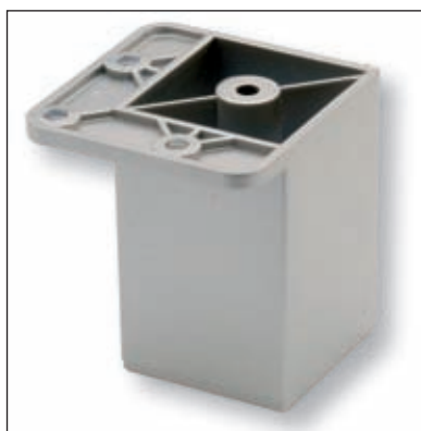
8110/70 H = 70 mm 62x62 (46x46 mm) furattávolság: 32 mm teherbírás: max. 200 kg króm 00014103710 alumínium 00014103711 matt nikkél 00014103712
